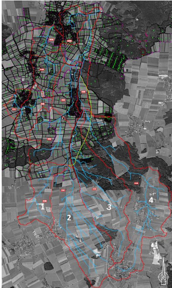
Abbildung 17: Für die Bemessung der straßenbegleitenden Mulde abgegrenzten Einzugsgebiete im Planungsraum. Die grüne Linie entspricht der vorgesehenen Trassierung der Mulde bzw. der Ortsumfahrung (Unterlage 18.5.4)
